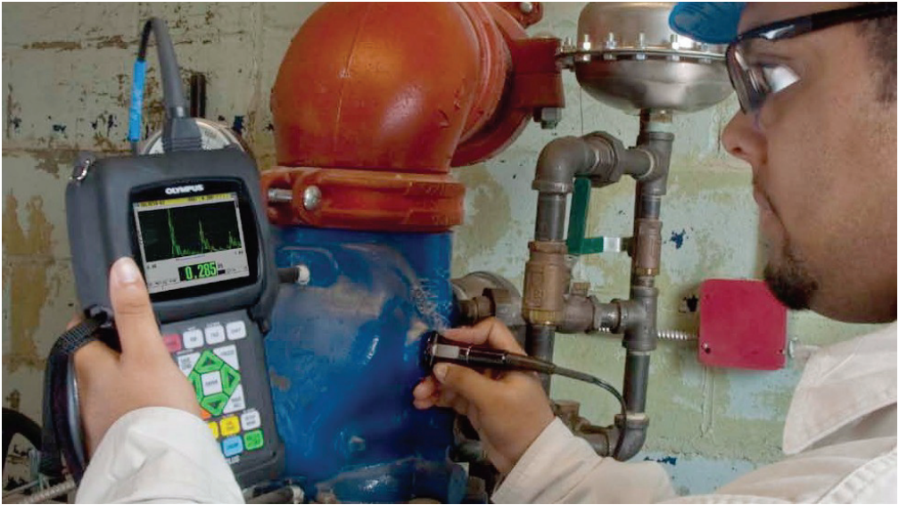
图 1-1 使用 38DL PLUS 仪器测量厚度
